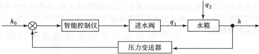
图 1-4 水箱液位自动控制系统的原理框图
