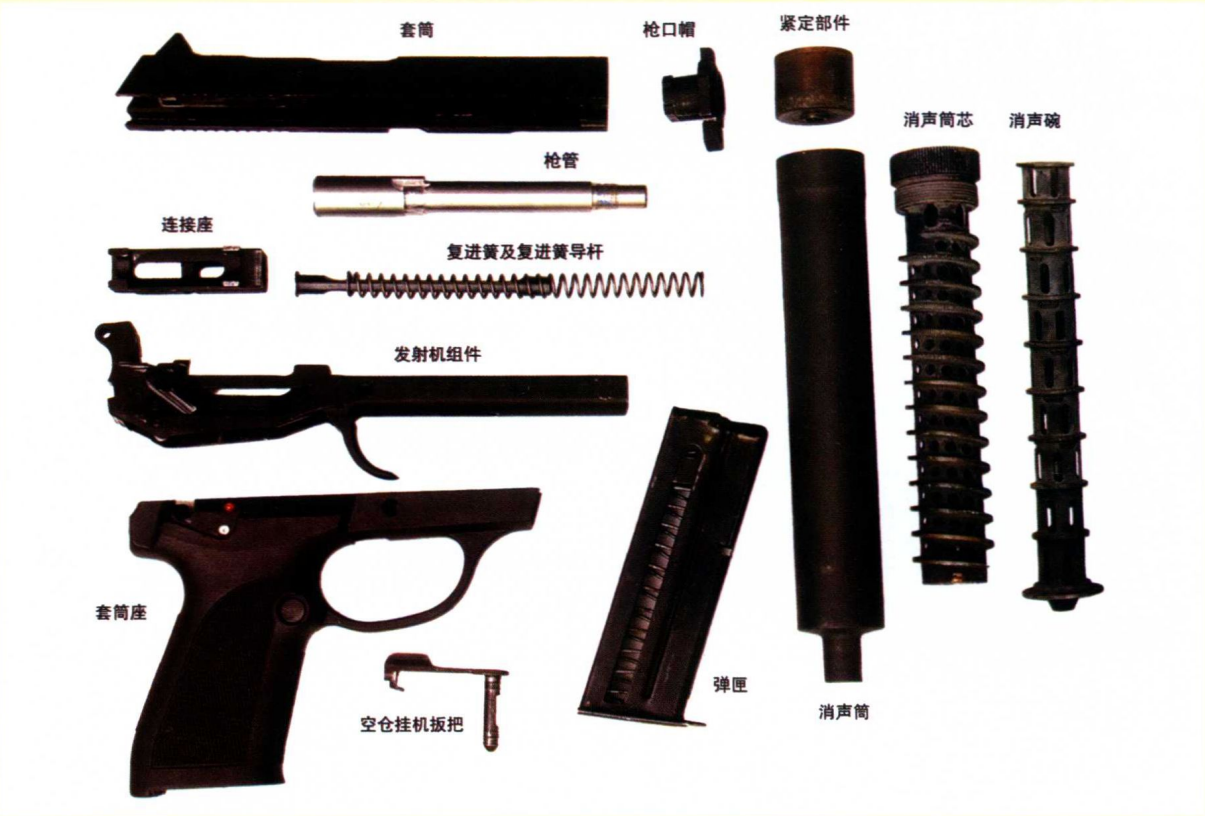
▲ QSW06 式 5.8 毫米微声手枪不完全分解
