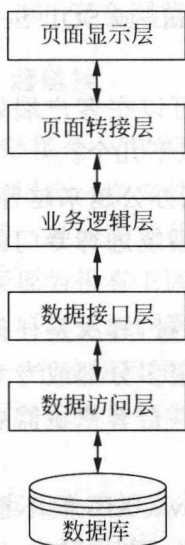
图 1-1 Web 系统的多层结构图 结构在层与层之间相互独立,任何一层的改变不会影响其他
