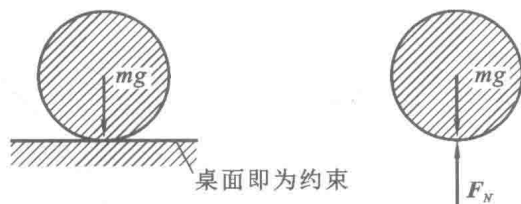
图 1-7 约束力确定示意图
