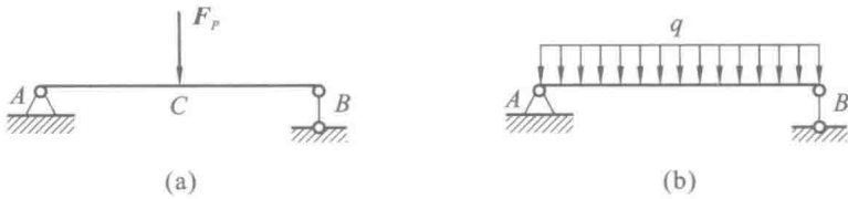
图 1-1 集中力与分布力 (a) 集中力; (b) 分布力
