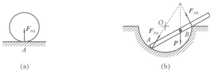
图 1-9 光滑接触面约束
