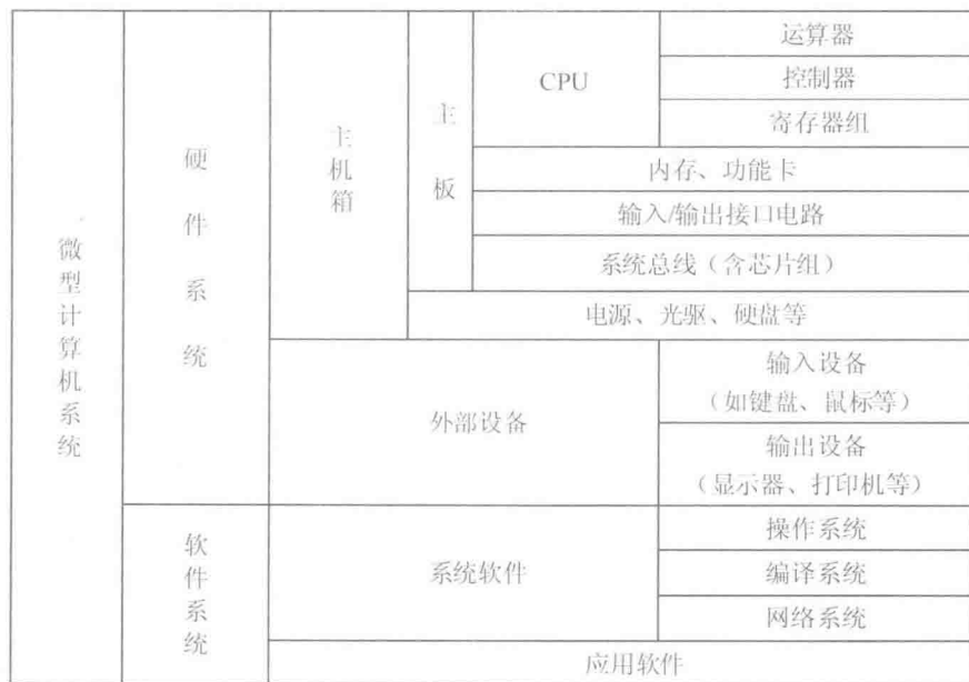
图 1-2 微型计算机系统的组成
