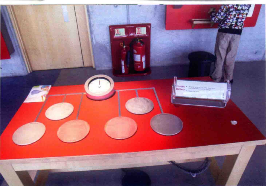
△ 人体电池。按照伏打电堆原理，不同的金属相接触会产生电流和电压。把两只手放在不同的金属板上，人体做导体就实现了金属之间的接触，从而产生电流。
