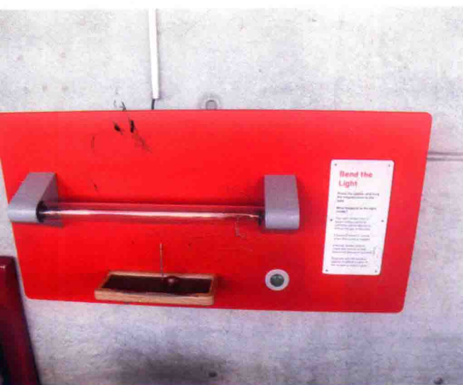
◇ 光线弯曲。打开开关，玻璃管中有光线穿过。当磁铁靠近玻璃管时，光线会发生弯曲。原因是光线原本由电子束撞击管子中的气体而产生，在磁铁的磁场作用下，电子束的轨道发生改变，光线也跟着弯曲。
