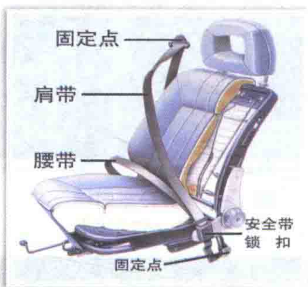
图 1-11 安全带的基本结构
