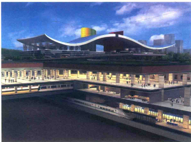
图 0-1 深圳福田地下火车站剖面效果图
