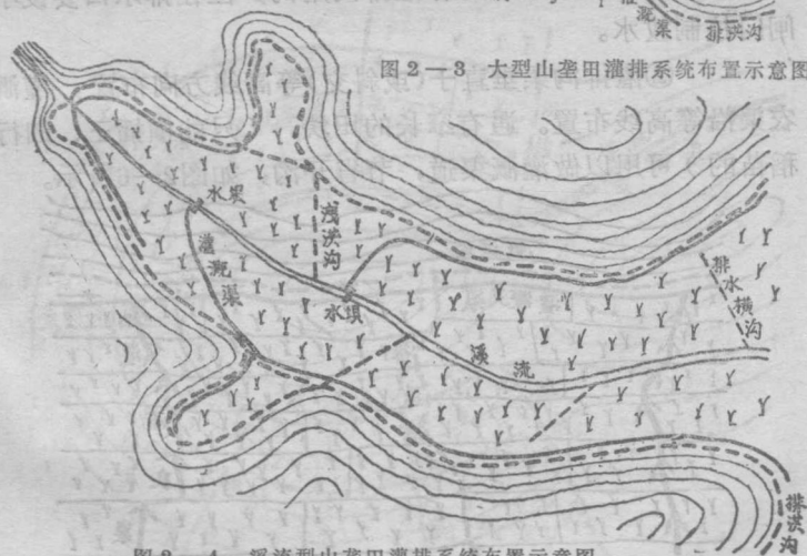
图 2—4 溪流型山垄田灌排系统布置示意图
