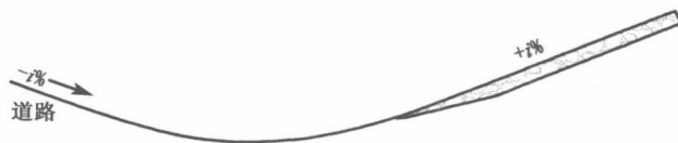
图 1-10 上坡制动床型避险车道
