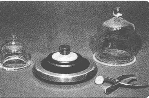
图 1-4 国际千克基准的复制品 (存放在位于布伦瑞克的联邦物理 - 技术院)
