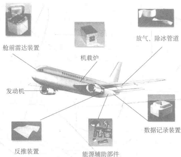
图 1.2 低热导材料在航空航天飞行器的应用
