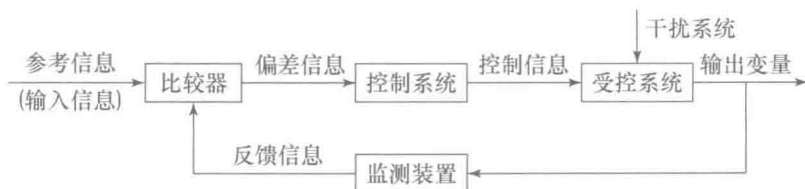
图 1-2 反馈控制系统示意图
