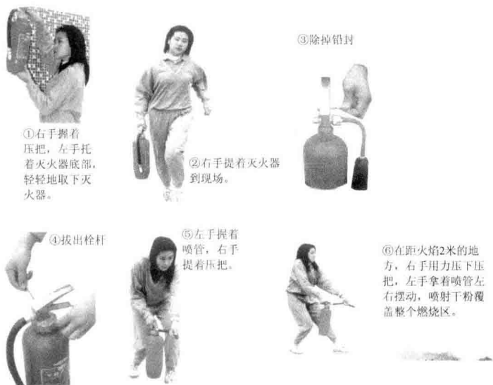
图 1-2 干粉灭火器的使用方法
