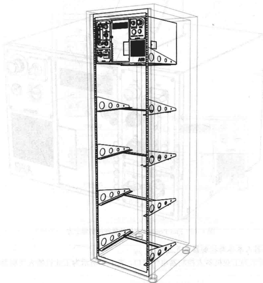
图 1-9 IRC5C 紧凑型控制器放置在机柜上水平安装方式
