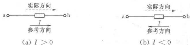
图 1.2.2 电流参考方向与实际方向的关系
