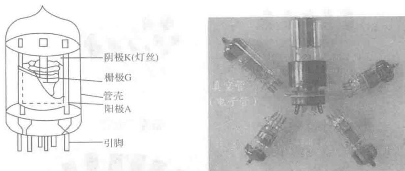
图 1.2.1 电子管结构示意图和实物照片
