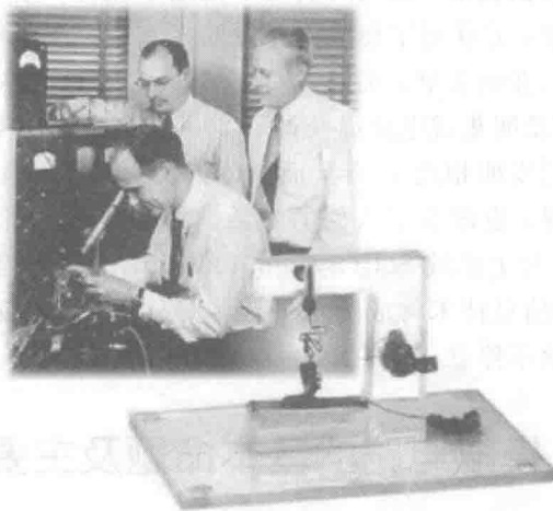
图 1.2.2 晶体管发明者与点触式晶体管实验装置
