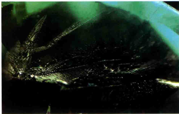
图1-1-4 助熔剂法合成祖母绿内部流体包裹体（40X，暗域照明法）
