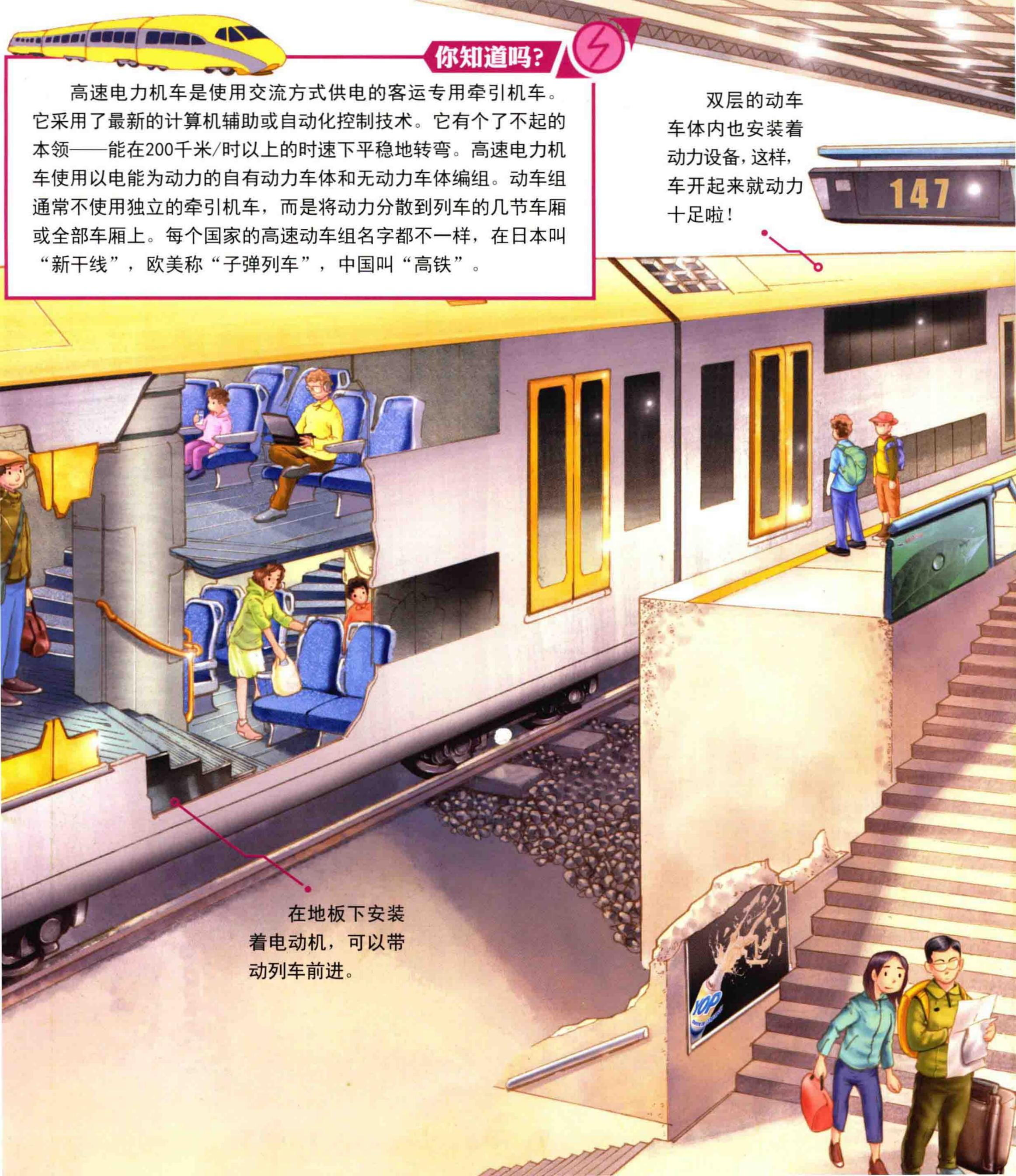
在地板下安装着电动机，可以带动列车前进。
