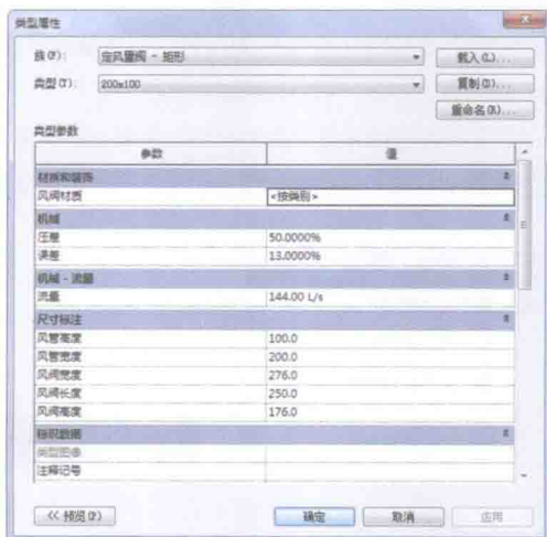
图 1-4 定量风阀 - 矩形
