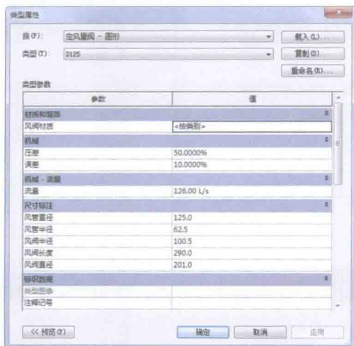
图 1-3 定量风阀 - 圆形
