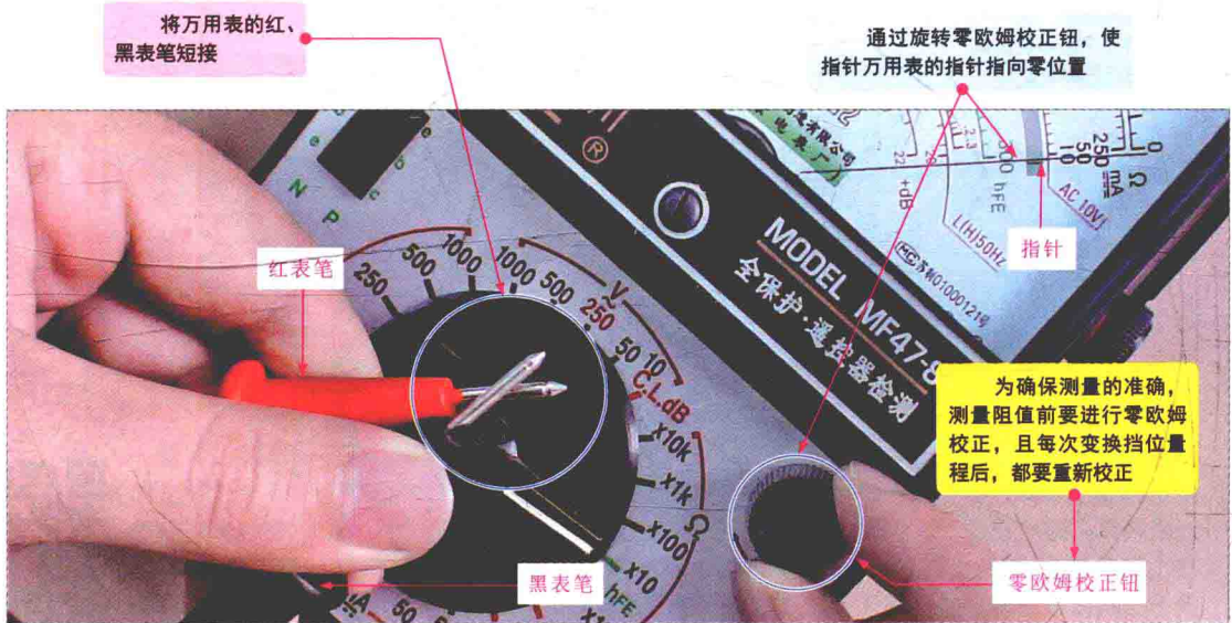
图1-12 指针万用表零欧姆校正钮
