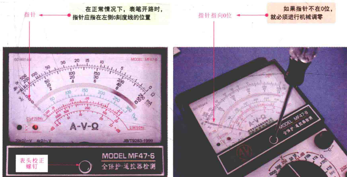
图1-9 指针万用表的表头校正螺钉
