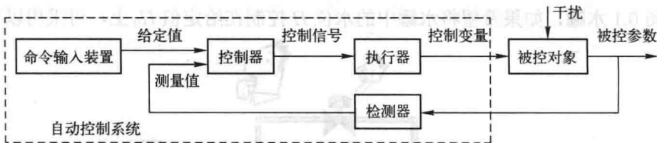
图 0.3 一般自动控制系统方框图 1
