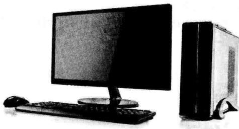
图 1-1b 计算机机箱类型——紧凑型塔式机箱
