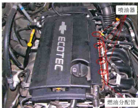
图 1-1-12 科鲁兹 1.6SL AT 型轿车 燃油供给系统的组成
