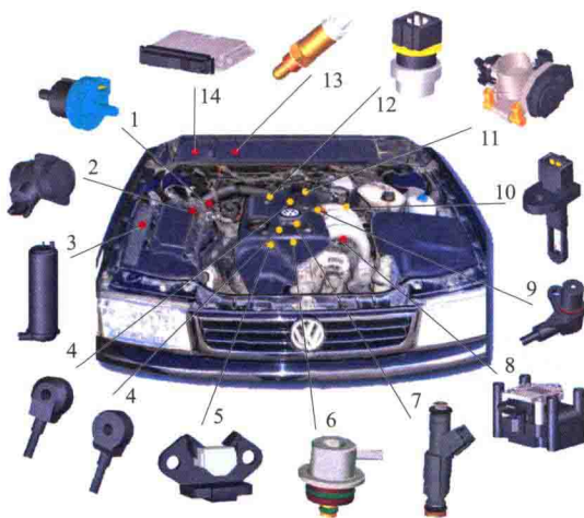
图 1-1-1 电控系统在汽车上的安装位置及零部件的分配
