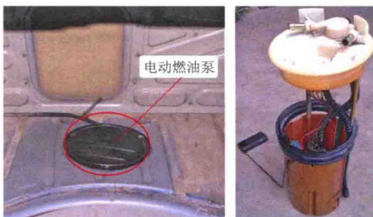
图 1-1-15 电动燃油泵安装位置及结构
