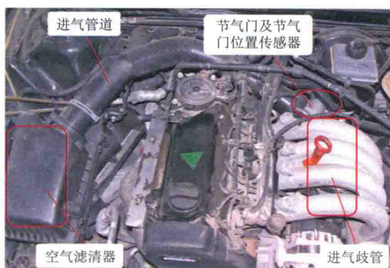
图 1-1-18 桑塔纳志俊轿车空气供给系统的组成
