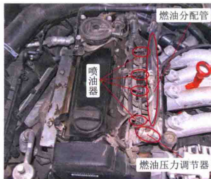
图 1-1-14 桑塔纳志俊轿车燃油供给系统的组成
