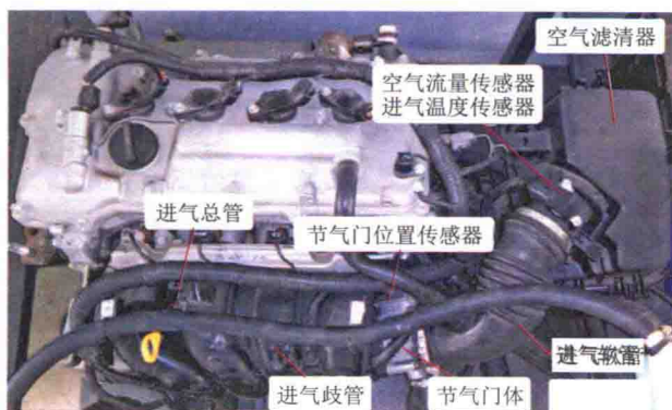
图 1-1-17 卡罗拉 GL 型轿车空气供给系统的组成
