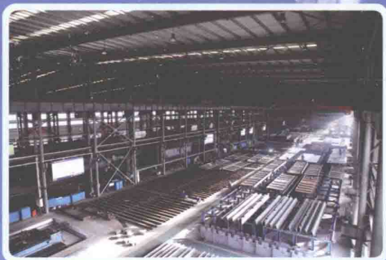
重庆东水门长江大桥钢结构件的生产
