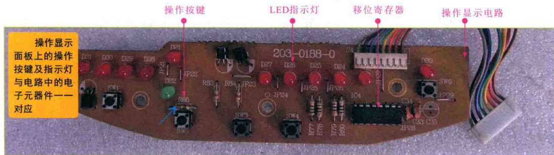
图1-13 电磁炉中的操作显示电路
