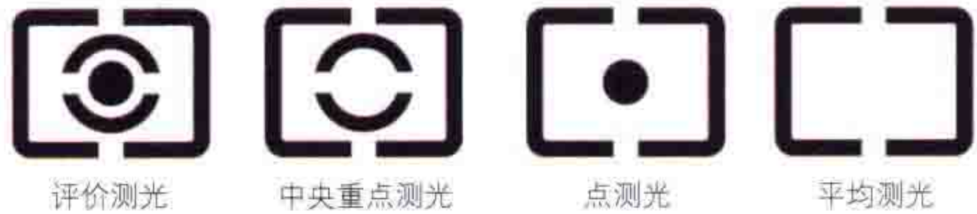
以佳能相机为例，机内提供了4种测光模式
