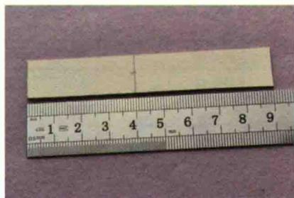
③ 在钻孔标记上钻一个直径 2mm 的小孔，之后用橡皮把铅笔的痕迹擦干净，最后得到一块背板。
