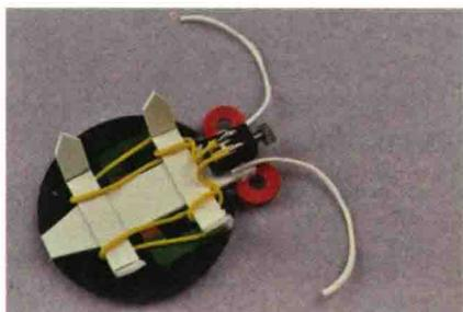
**注意：**这里也可以用502胶水粘贴，不过要特别注意控制用量，防止胶水过多，渗入振动电机内部，导致电机损坏。
