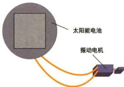
② 把太阳能电池板上引出的两根导线，直接焊接到振动电机的两根电极上。
