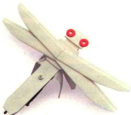
机器人在设计上倡导一定的规范：机械结构和电子电路相对独立，机械部件和外形结构基本都用 PVC 材料来制作，控制电路则主要借助标准的电路板来焊接，并尽可能放置在 PVC 材料制成的外壳之下，同时强调鲜明、有趣的造型效果，不仅适合青少年遵循一定的方法完成制作，更可以引导他们发挥想象力并施展创意。
