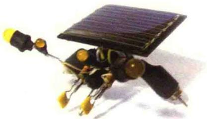
BEAM 机器人的概念最初是由著名的机器人专家马克·特尔顿（Mark Tilden）博士提出的，马克博士曾为美国宇航局（NASA）工作，后来加入著名的 WowWee 玩具制造公司，并设计了曾经享誉全球的人形玩具机器人——罗本史宾（Robosapien）。BEAM 机器人最基本的想法来自于构建像生物一样具有简单条件反射机能的机器，区别于实验室里追求的高、精、尖的人工智能的机器人技术，马克博士主张从最基本的模仿自然生物某一功能的简单机器人做起，类似自然界生物进化一样，从简单到复杂，逐步实现机器人的“进化”。
