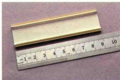
② 把线槽盖子两侧的轨道裁切掉，得到一根长 9cm、宽 1.5cm 左右的 PVC 方条。用铅笔在 PVC 方条上距离其中一侧边缘 4cm 的地方用铅笔画一根横截线，并且在横截线中央位置做一个钻孔标记。
