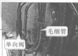
电磁四通阀、毛细管、单向阀是空调器室外机制冷系统中主要的阀门及节流组件。电磁四通阀主要起制冷、制热工作状态的切换；毛细管主要用于节流和降压；单向阀用于控制制冷剂的流向
