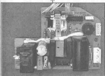
6 电源电路为空调器提供工作电压，确保空调器的工作条件。控制电路是整个空调器电路的控制核心，完成各电路和部件的协调工作
