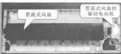
5 空调机室内机的显示及遥控接收电路用来接收遥控器发来的信号。贯流式风扇组件由贯流式风扇和驱动电动机组成
