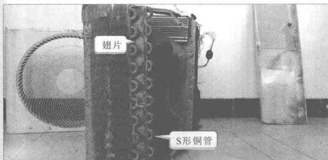
3 冷凝器是室外机中重要的热交换部件。它与蒸发器的作用正好相反。一般情况下，冷凝器安装在室外机轴流风扇的后部，由多组S形铜管胀接铝合金散热翅片。其中S形铜管用于传输制冷剂使制冷剂在其内部不断的循环流动，翅片用来增大散热面积迅速地实现热交换，从而有效地提升冷凝器的散热效率
