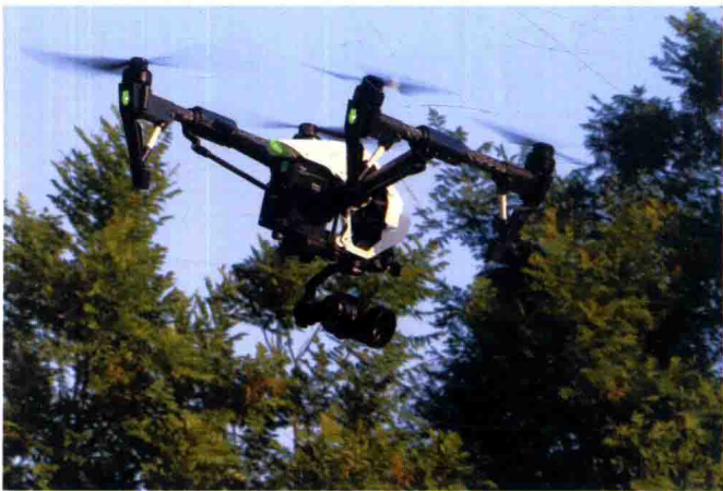
用于航空遥摄的小型四轴无人直升机，被百姓称为“会飞的相机”。
