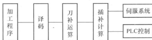
图 1-3 CNC 系统的数据转换过程
