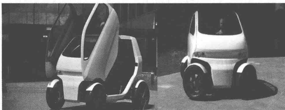
车辆可侧向行驶四个车轮可实现90°转向
