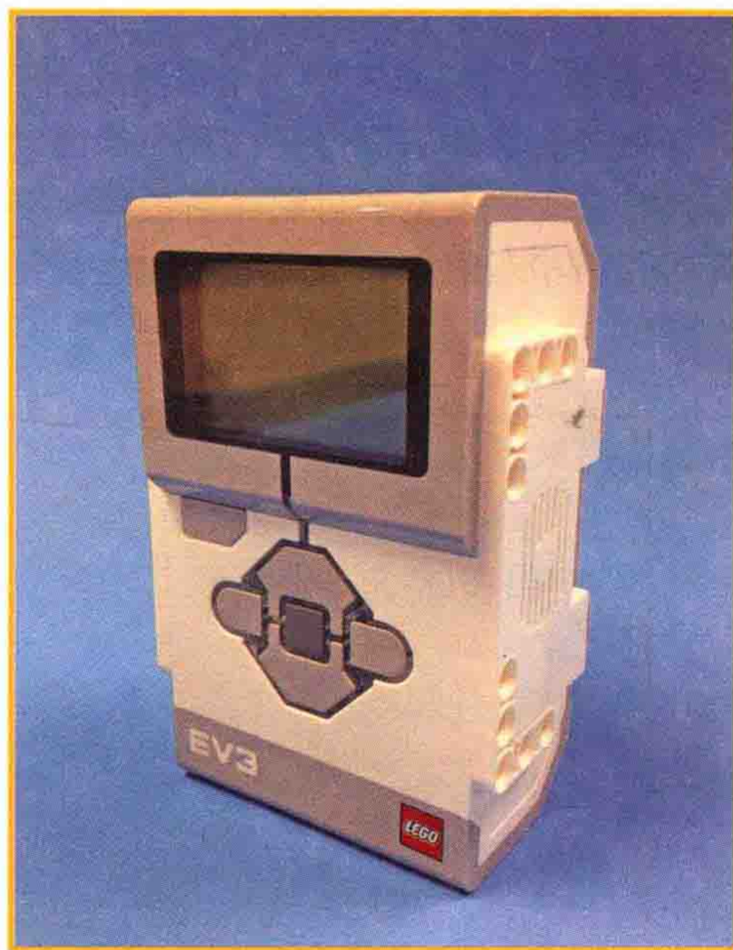
图 1.1 EV3 程序块可以用程序控制你的机器人
