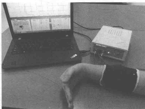
图 1-7 用肌电信号测试仪进行评估
