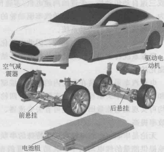
图 1-3 电池安置于底盘中间（特斯拉 MODEL S）
