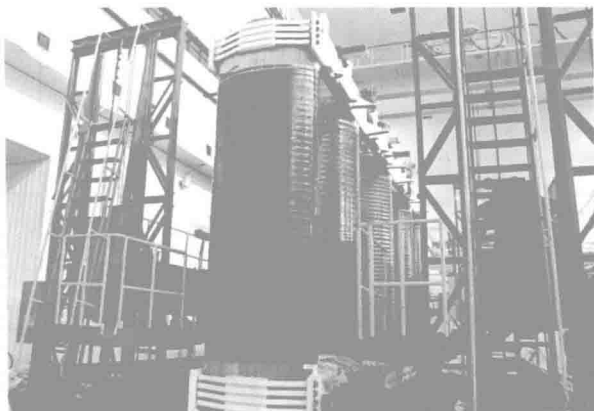
图 1-7 采用热缩带绑扎的铁芯
