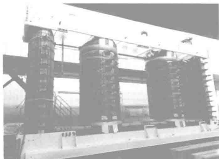
图 1-2 单相二柱旁轭式铁芯结构图
