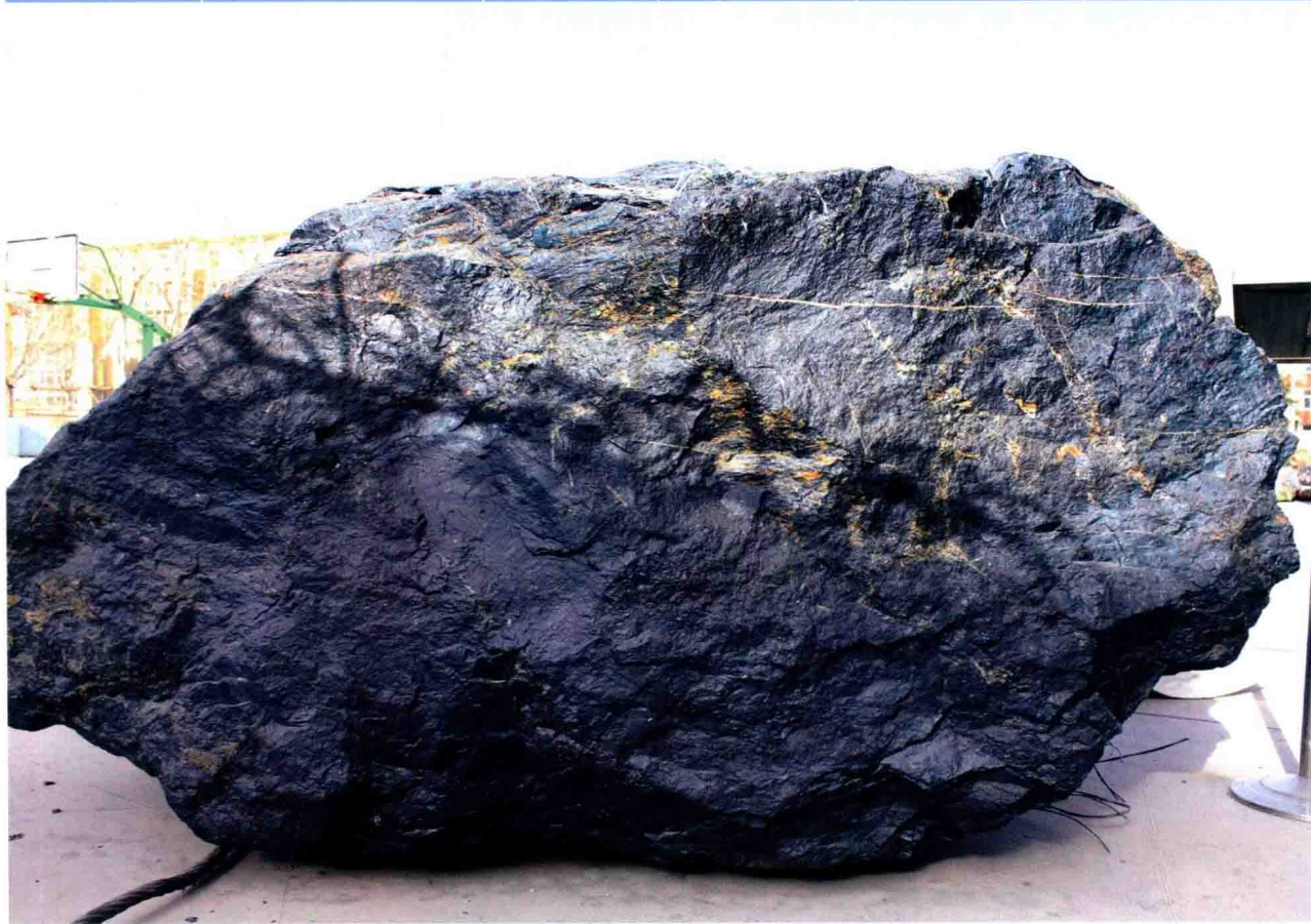
本矿石标本采自矿区北一矿体。标本表面为泥灰色，新鲜面为钢灰色，具微晶、变余粉砂-砂状结构，片状、条带状构造。矿石矿物主要有鳞片状赤铁矿、鲕状假象赤铁矿及少量磁铁矿；脉石矿物有石英、绢云母、透闪石、方解石等。TFe 品位为53.6%
