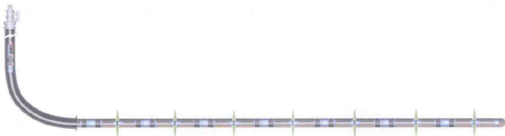
图1.19 Barnett页岩气裸眼水平井多级压裂方法示意图
