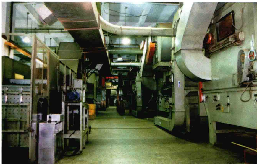
图版 48-009-1 宁波卷烟厂“八五”技改项目全叶打叶线(1995年摄,宁波卷烟厂提供)
