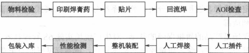
图 1-1 某传感器生产工艺流程
