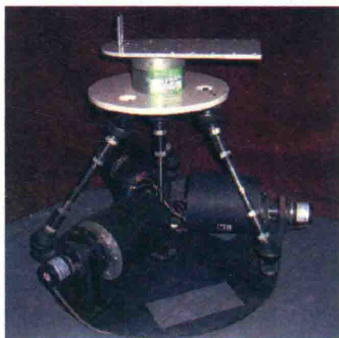
图 1-12 3-RSS 踝关节外骨骼助行机器人
