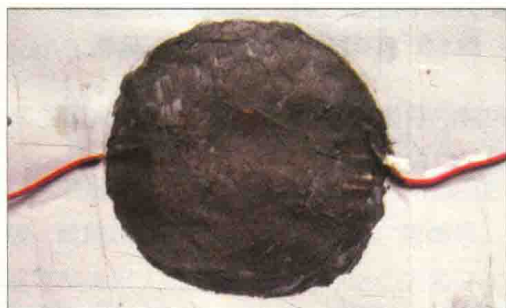
■ 图 1.3 圆形石墨涂层，直径约 8\text{cm} ，阻值约 800\Omega
