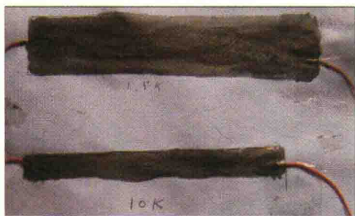
■ 图 1.2 条形石墨涂层（经测量，粗条阻值约 1.5\text{k}\Omega ，细条阻值约 10\text{k}\Omega ）
