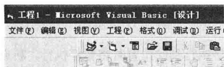
图 1-1 设计模式下的标题栏
