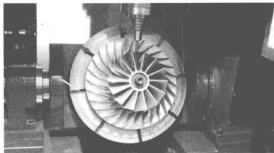
图 1.7 调整刀轴方向避免干涉
