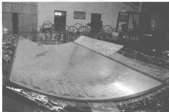
图 1.3 火箭贮箱筒段壁板展开图
