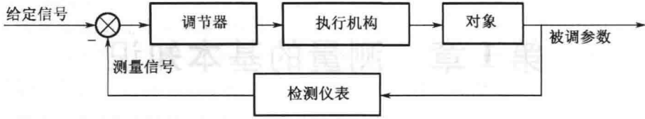
图 1-1 控制系统示意图
