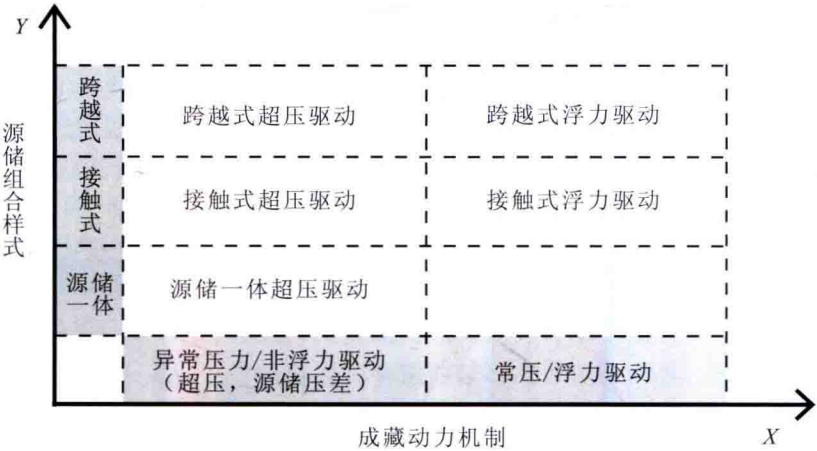
图 1-5 内源源内、近源和远源亚油气成藏体系内细分类型示意图
