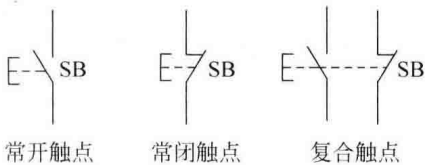
图 1-5 按钮开关的图形和文字符号
