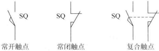
图 1-9 行程开关触点符号
