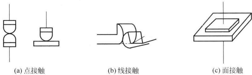
图 1-2 触点的 3 种接触形式结构示意图
