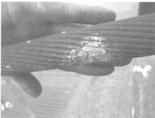
图 1-3 脱冰跳跃引起的导线闪络烧伤
