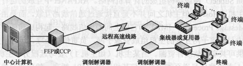
图 1.2 以单计算机为中心的远程联机系统
