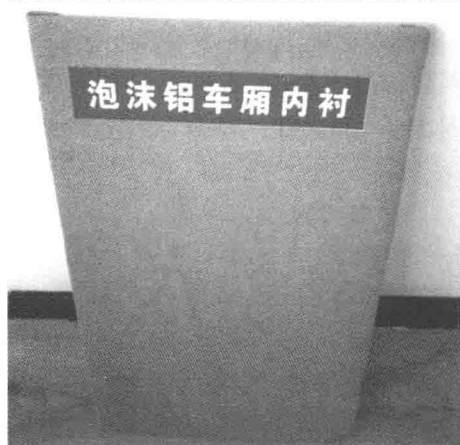
图7 泡沫铝吸声板与粘贴纤维装饰布的泡沫铝吸声板
