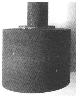
图12 连接导电杆的惰性阳极试样
